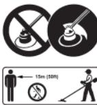
Föremål som slungas iväg kan orsaka allvarliga skador. Arbeta bara med korrekt monterat skydd för motorlien eller grästrimmern och klipphuvudet. Håll ett avstånd på minst 15 m (50 ft.) till andra i närheten.
