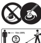
Föremål som slungas iväg kan orsaka allvarliga skador. Arbeta bara med korrekt monterat skydd för motorlien eller grästrimmern och klipphuvudet. Håll ett avstånd på minst 15 m (50 ft.) till andra i närheten.
