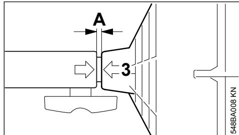
après l'emboîtement correct, la grille de protection (3) doit affleurer avec le manchon d'accouplement (fente A de 5 mm au maximum) ;
