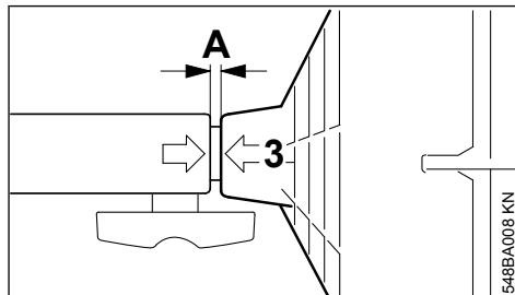
Richtig eingeschoben muss das Schutzgitter (3) mit der Kupplungsmuffe bündig (Spalt A maximal 5 mm) sein.
