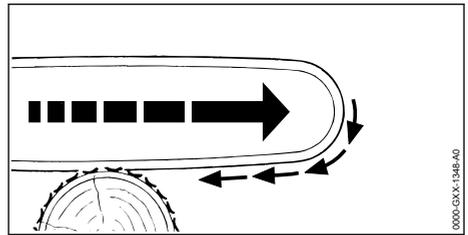
Lorsqu'on travaille avec le côté inférieur du guide-chaîne, la tronçonneuse est tirée dans le sens opposé à l'utilisateur.
