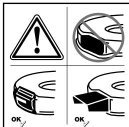
Niebezpieczeństwo zranienia – pracować tylko z zamontowanym zespołem wyrzutowym.
