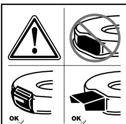
Perigo de ferimentos – trabalhar só com o dispositivo de expulsão instalado.
