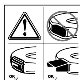
Nebezpečí poranění – pracujte pouze s namontovanou vyhazovací koncovkou.
