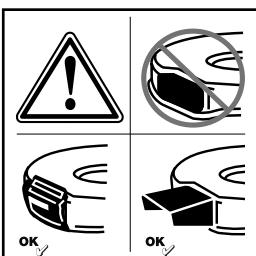
Pericolo di ferite – lavorare solo con l'espulsore montato.
