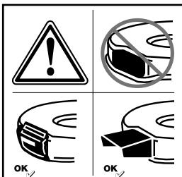
Verletzungsgefahr – nur mit angebautem Auswurf arbeiten.
