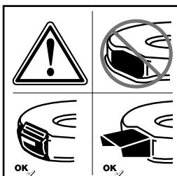
Опасность травмирования – работать только с установленным выбрасывателем.
