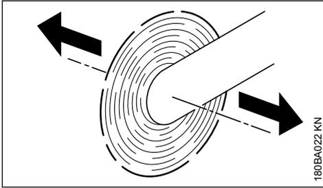
Lorsqu'on déplace une découpeuse dans le sens de la flèche alors que le disque est en rotation, cela engendre une force qui a tendance à faire basculer la machine.
