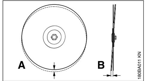
En cas de faux-rond excessif (A), les segments diamantés sont soumis à de trop fortes sollicitations et deviennent extrêmement chauds. Les contraintes thermiques peuvent causer une fissuration du corps de la lame et les segments peuvent être détremés par une surchauffe.
