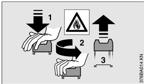
Ne jamais utiliser un outil pour ouvrir ou fermer le bouchon de réservoir à baïonnette. En effet, cela pourrait endommager le bouchon et du carburant risquerait de s'échapper.
