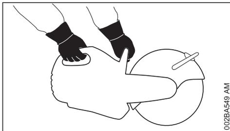
Toujours tenir fermement la machine à **deux mains** : main droite sur la poignée arrière – ceci est également valable pour les gauchers. Pour pouvoir guider la machine en toute sécurité, empoigner fermement la poignée tubulaire et la poignée de commande en les entourant avec les pouces.
