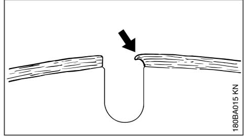
Si l'on poursuit le travail avec des segments engorgés, manquant de mordant, ces segments peuvent se ramollir sous l'effet de la forte chaleur dégagée – la solidité du corps du disque surchauffé se dégrade – cela peut engendrer des contraintes nettement reconnaissables aux mouvements oscillants du disque. Ne pas poursuivre le travail avec ce disque – **risque d'accident !**
