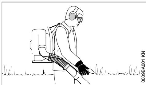
L'apparecchio si utilizza portandolo sulla schiena. La mano destra sull'impugnatura di comando guida il tubo soffiatore.
