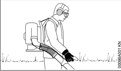
Het apparaat wordt op de rug gedragen. De rechterhand bedient de blaaspijp via de bedieningshandgreep.
