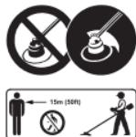
Voorwerpen kunnen in alle richtingen worden weggeslingerd of afketten. Om het risico van verwonding van de bediener door weggeslingerde voorwerpen te verminderen, mag u nooit een motorzeis gebruiken zonder correct geconfigureerde en correct geïnstalleerde beveiliging. Houd omstanders op ten minste 15 m (50 ft.) afstand.
