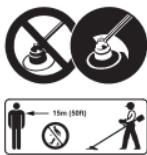
Gegenstände können in alle Richtungen geschleudert werden oder abprallen. Zur Minderung des Verletzungsrisikos des Benutzers durch weggeschleuderte Gegenstände niemals eine Motorsense ohne korrekt konfigurierte und korrekt angebauten Schutz benutzen. Halten Sie umstehende Personen mindestens 15 m (50 ft.) entfernt.
