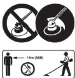
Obiectele pot fi aruncate sau pot ricoșa în toate direcțiile. Pentru reducerea riscului de vătămare a utilizatorului cu obiecte aruncate, nu folosiți niciodată o motocoasă fără un dispozitiv de protecție
