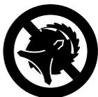
Il est interdit d'utiliser ce capot protecteur avec des couteaux à taillis, des couteaux de broyage, des couteaux à herbe ou des scies circulaires.
