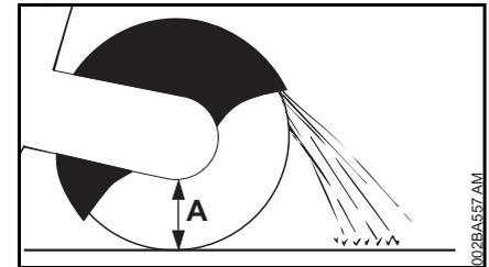
La procédure dépend du diamètre extérieur du tube et de la profondeur de coupe maximale possible avec le disque à découper (A).
