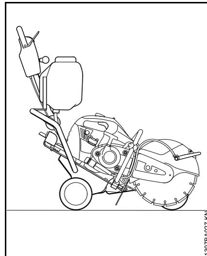
La découpeuse à disque peut être aisément installée sur le chariot de guidage STIHL FW 20 (accessoire optionnel).
