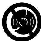
Vérifier fréquemment le disque à découper – le remplacer immédiatement s'il présente des fissures, des bombements ou d'autres dommages (par ex. des traces de surchauffe), car il pourrait casser – **risque d'accident !**
