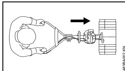
Le moteur MultiSystème muni du démousseur MF-MM doit être utilisé en avançant.
