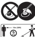
Gegenstände können in alle Richtungen geschleudert werden oder abprallen. Zur Minderung des Verletzungsrisikos des Benutzers durch weggeschleuderte Gegenstände niemals eine Motorsense ohne korrekt konfigurierten und korrekt angebauten Schutz benutzen. Halten Sie umstehende Personen mindestens 15 m (50 ft.) entfernt.
