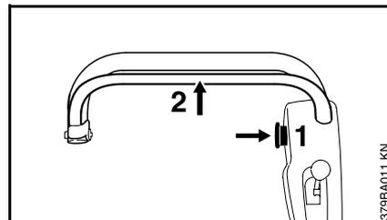
La commande d'accélérateur n'a pas lieu par la gâchette de la poignée arrière de la découpeuse, mais par l'intermédiaire de la commande d'accélérateur au guidon.
