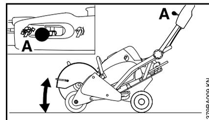
**Position B – verrouillage –** pour caler la profondeur de coupe réglée et pour travailler avec une profondeur de coupe régulière.
