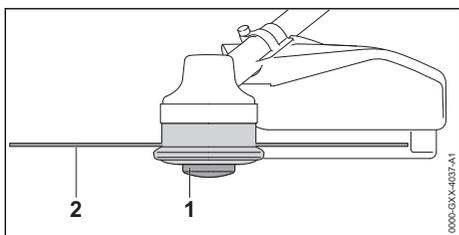
Si la longueur des fils de coupe qui dépasse est inférieure à 25 mm, une sortie automatique des fils de coupe n'est pas possible.
