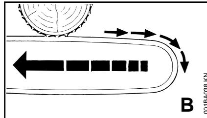
Si lorsqu'on coupe avec le côté supérieur du guide-chaîne – coupe par le dessous – la chaîne coince ou touche un corps étranger noyé dans le bois, la tronçonneuse peut être repoussée en arrière, en direction de l'utilisateur – **pour éviter ce phénomène :**
