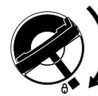
Dans le cas du bouchon de réservoir à ailette rabattable (verrouillage à baïonnette), le présenter correctement, le faire tourner jusqu'en butée et rabattre l'ailette.
