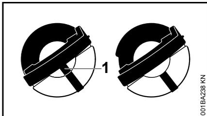
À gauche : la partie inférieure du bouchon du réservoir est décalée – le repère intérieur (1) coïncide avec le repère extérieur.
