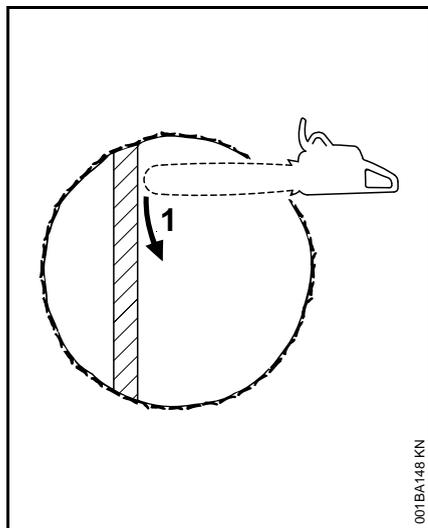
Exécuter une coupe en éventail suivie si le diamètre du tronc dépasse la longueur de coupe de la tronçonneuse.
