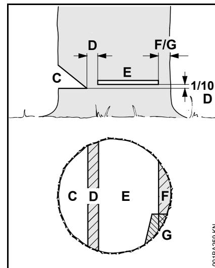
**L'entaille d'abattage (C)**, ou entaille de direction, détermine la direction de chute de l'arbre.
