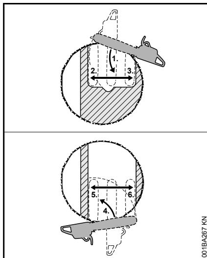
Choisir ce genre de coupe d'abattage lorsque le diamètre du tronc est supérieur à la longueur de coupe de la tronçonneuse.
