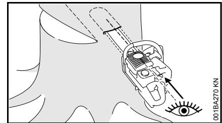
Si possible, utiliser la nervure de visée pour mortaisage. La nervure de visée pour mortaisage est parallèle au bord supérieur ou inférieur du guide-chaîne.
