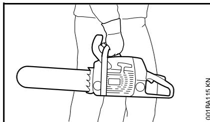
Toujours porter la tronçonneuse seulement par la poignée tubulaire – le silencieux très chaud étant tourné du côté opposé au corps – et le guide-chaîne étant orienté vers l'arrière. Ne pas toucher aux parties très chaudes de la machine, tout spécialement à la surface du silencieux – risque de brûlure !
