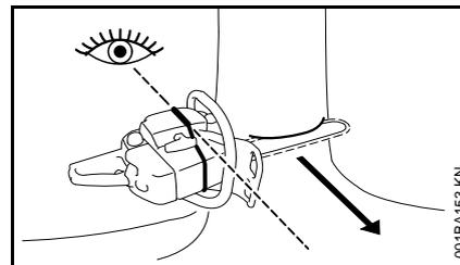
Cette tronçonneuse est munie d'une nervure de visée, sur le capot et sur le carter de ventilateur, qui aide à déterminer la direction de chute. Utiliser cette nervure de visée.
