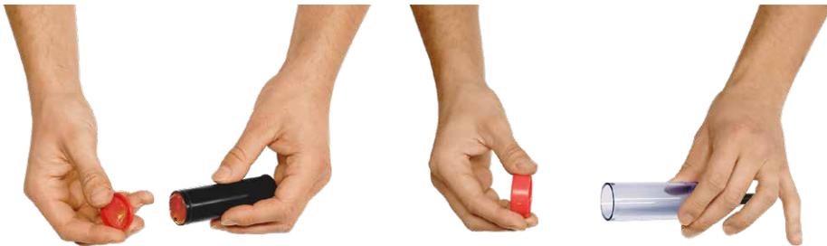
3. Insérer la cartouche de graisse dans la pompe (graisse apparente coté pompe).
