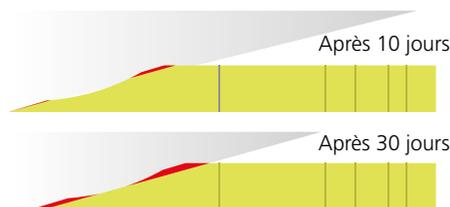
L'**affilage** consiste à retrouver le côté tranchant de la lame et permet d'optimiser la qualité de coupe. Effectuer 4 passages avec l'affiloir carbure (disponible chez INFACO, réf. 950AF) sur le biseau + 1 passage sur le contre biseau (arrière de la lame).
