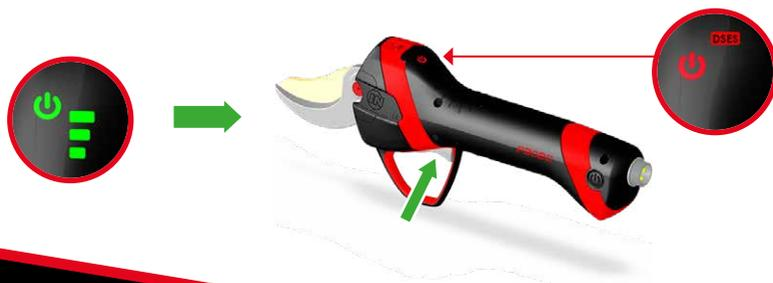
3. Tout en maintenant la gâchette, mettre en contact le dessous du crochet directement sur l'extrémité des doigts de la main opposée à celle qui tient le sécateur équipée ou non d'un gant conducteur INFACO selon le choix de votre configuration de travail.
