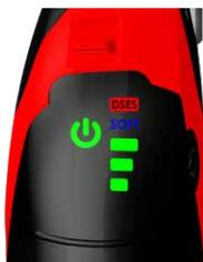
À la mise sous tension, vérifier le bon état de fonctionnement de toutes les LED
