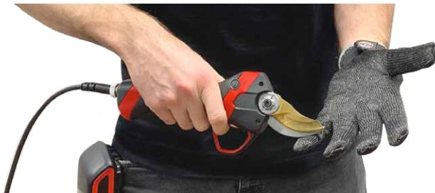
4. Parcourir ainsi la totalité de la surface de la main et/ou du gant (paume de la main et des cinq doigts, côté intérieur et extérieur), tout en maintenant la gâchette enfoncée afin de constater, via le bargraphe, les différents niveaux de conductivité de votre main gantée ou non :
