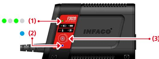
3. Processus d'hivernage terminé : la LED de mise en hivernage (2) reste bleu fixe et la LED d'état (1) est passée au vert fixe.
