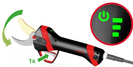
1. En respectant les détrompeurs des prises, connecter successivement le cordon à la batterie puis au sécateur.
