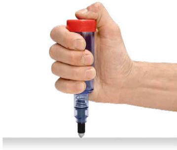
2. Retirer le bouchon de la cartouche de graisse ainsi que le bouchon de la pompe.
